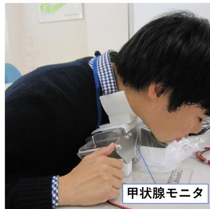
本装置の大きな特徴は可搬型でありながら遮蔽体を有している点であり、原子力災害の発災箇所近傍の高バックグラウンド環境下に装置を持ち込み検査を行うことが可能である。高バックグラウンド環境下での測定を目指した背景に、福島第一原子力発電所の事故時、避難所での測定の際、測定場所のバックグラウンド線量率が高く、詳細な甲状腺被ばく線量の評価が困難であったことがある。
