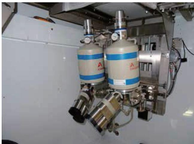
図2 高純度ゲルマニウム半導体検出器4基から構成される放射線測定器
